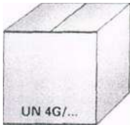
Slika 4: Zaboja embalaža brez odprtine, izdelana iz kovine, lesa, kartona, plastike (Vojko Robnik, Alojz Habič, Prevoz nevarnega blaga v cestnem prometu. Ljubljana: ZVD, 2000)
